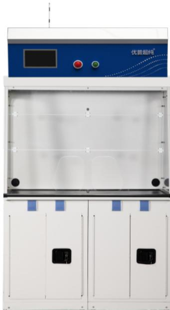
为什么自净化药品柜这么多的别称，自净化、净气型、无管道又是怎么做到的？自净化药品柜又称自净化无管道试剂柜、净气型无管道药品柜、净气型无管道试剂柜、净气型无管道储药柜等。净气型药品柜的风机常开模式下不只会主动吸附柜内所储存的危化品挥发的有毒有害气体，同时可以将实验室内的有毒有害气体吸进柜内，通过顶部的吸附过滤装置过滤实验室内的有毒有害气体，由此达到净化实验室内部空气的效果。自净化药品柜主要是用来保护实验室人员在存储化学品时带来的吸入危害，同时能够24小时不间断的对室内空气进行循环过滤
